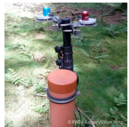
Messungen am TERENO-Standort-Wüstebach: Stativ mit PAR-Sensor (blau), R/FR-Sensor (rot) und SoilNet-Datenlogger (orange)
