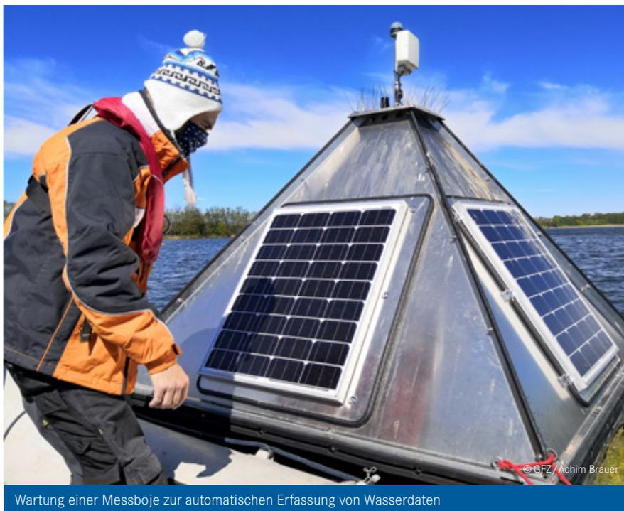
Wartung einer Messboje zur automatischen Erfassung von Wasserdaten
