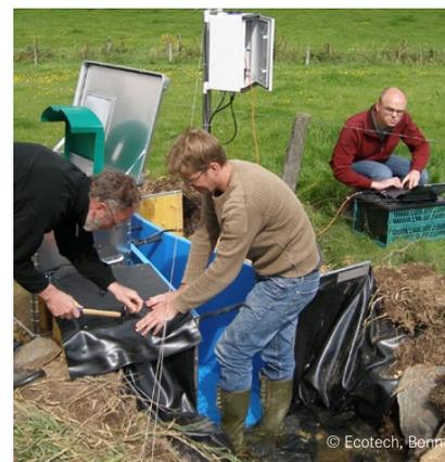
Aufbau einer hydrologischen Messstation in Rollesbroich
