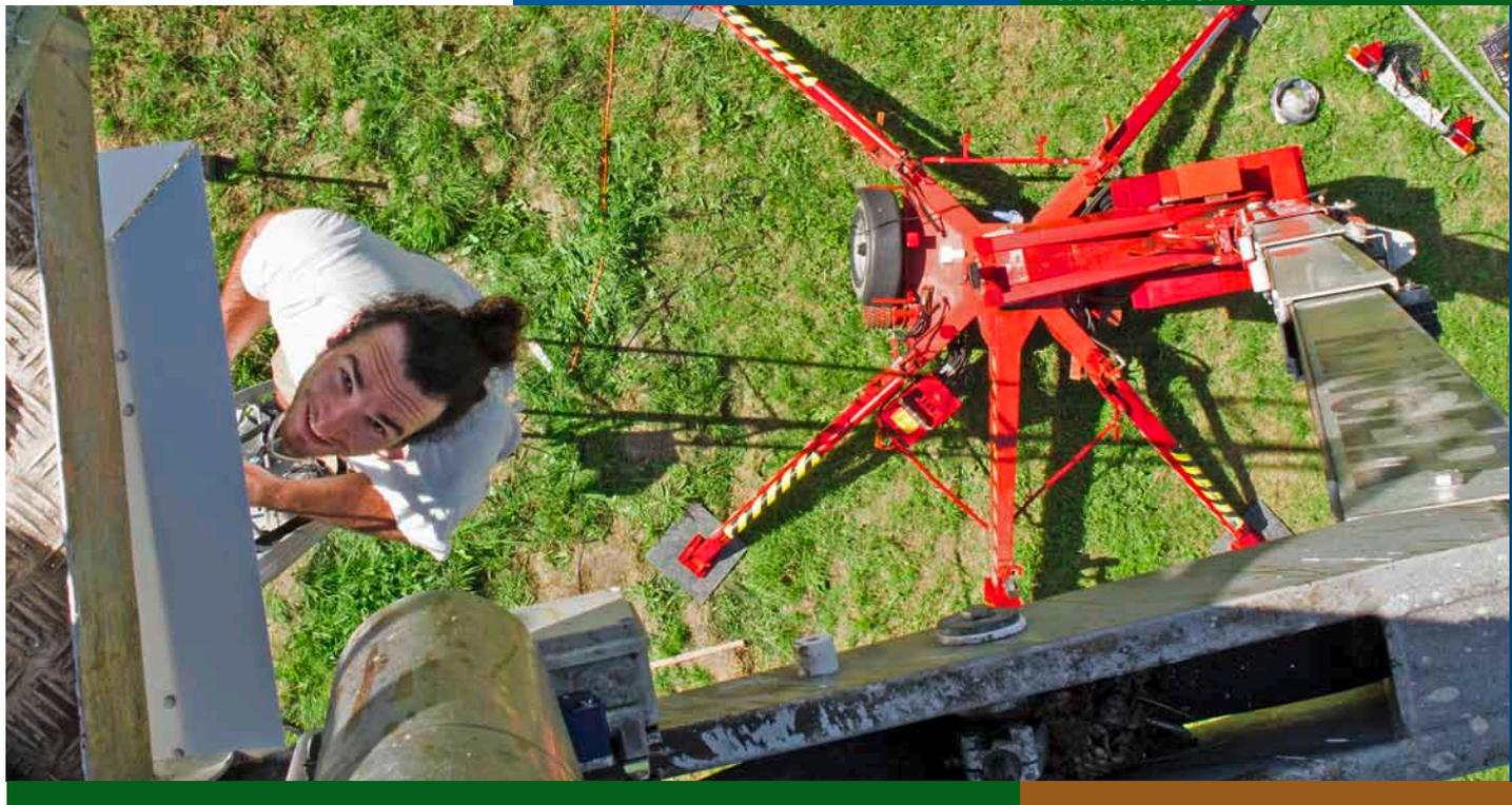
*Hoch hinaus: Christian Chwala vom Karlsruher Institut für Technologie montiert in luftiger Höhe ein selbst entwickeltes Messgerät, mit dem am Standort Fendt neue Methoden zur Niederschlags- und Luftfeuchtigkeitsmessung mittels Mikrowellenstrahlung erprobt werden*
