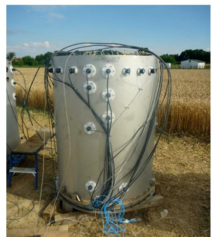
Abb. 3: Links: Stechen eines SoilCan Lysimeters am TERENO-Standort Dedelow; rechts: SoilCan Lysimeter mit unterschiedlicher Sensorik zur Messung von Bodenparametern (Fotos: W. Hierold, ZALF)
